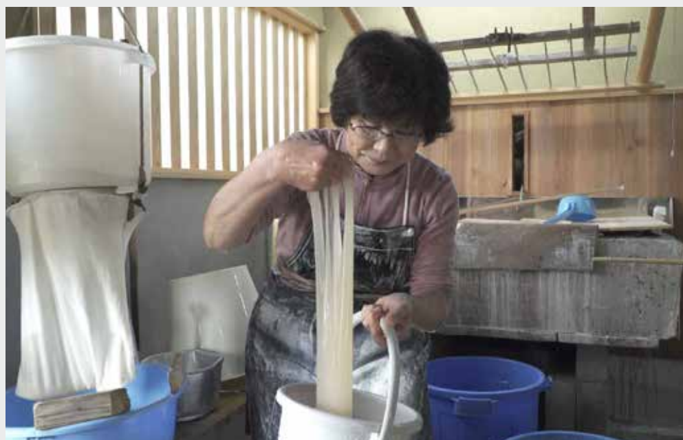
繊維を分散させる役割を担う ネリ（トロロアオイの根から抽出）を加えます
